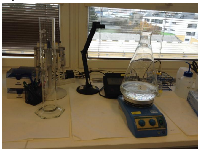
Obrázek 13 - Erlenmeyerova baňka na magnetické míchačce (Kozáková, 2016)
